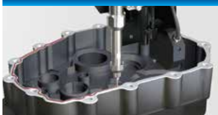
对引擎部件进行FIPG涂布
